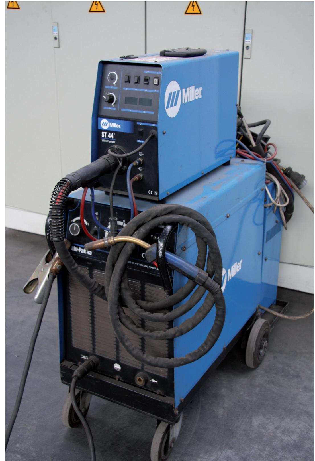
*La soldadura por arco eléctrico con protección de gas, es un proceso en el cual el calor necesario es generado por un arco que se establece entre un electrodo consumible y el sustrato metálico que se va a soldar.*
