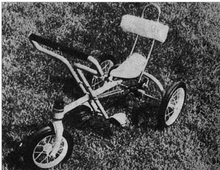
Vehículo de esfuerzo mínimo diseñado para niños que sufren de parálisis cerebral. Tanto los pedales como el asiento sirven para accionarlo. El niño obtiene impulso sirviéndose de cualquiera de sus miembros, en tanto que los demás van ejercitándose. Diseñado por Charles Lanius, estudiante de la Universidad de Purdue.
