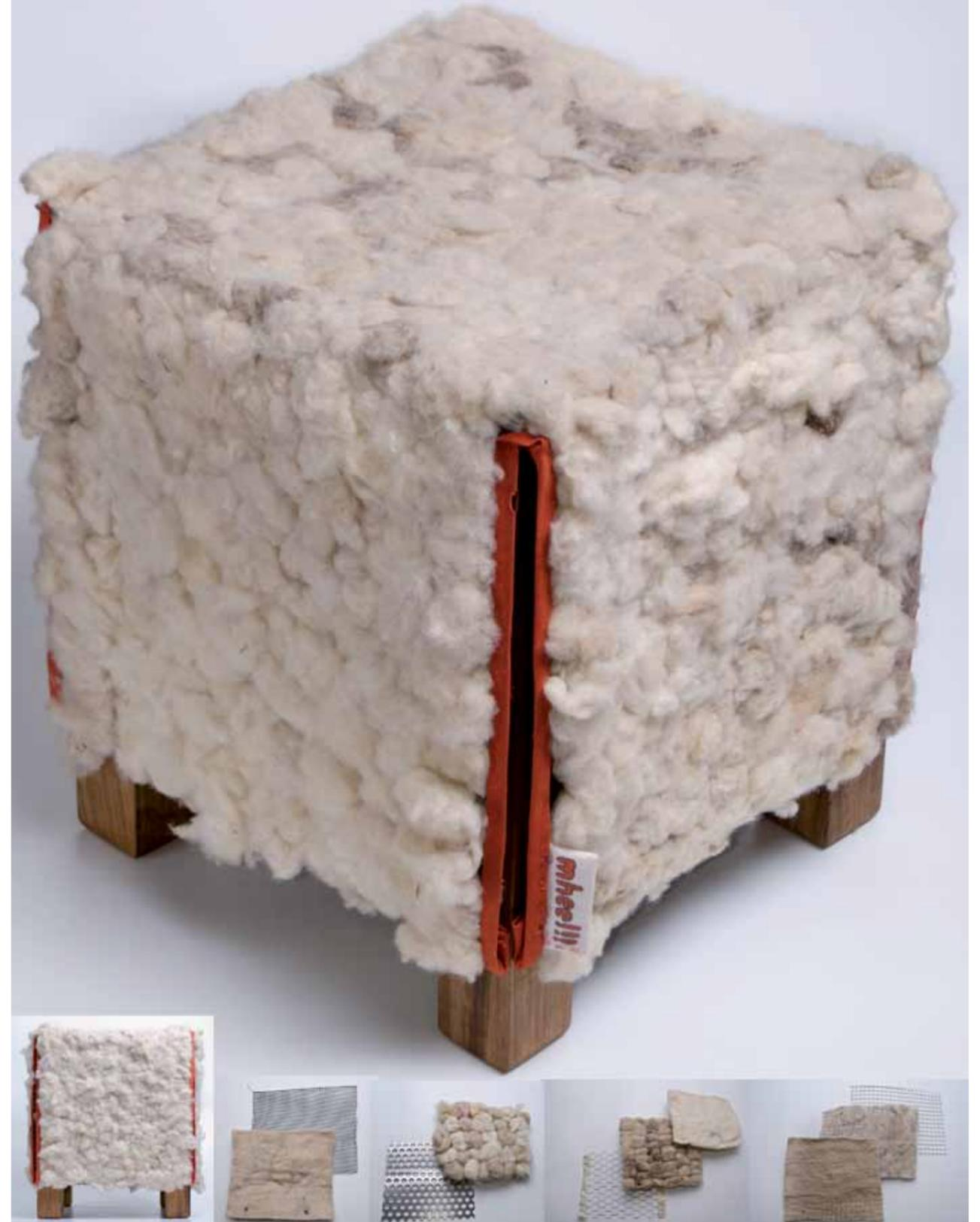
Desarrollo de diferentes materiales compuestos, con el condicionante de utilizar la lana como refuerzo. Resultado: Banco, matriz chapa perforada, refuerzo vellón de lana.
