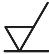
simbolo de mecanizado con arranque de viruta
